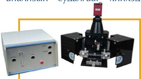
**Зориулалт:** Эс (бактери), уураг, нано эгэл биет, суспенз, эмульс суспензийн гадаргуугийн цахилгаан шинж чанарыг судлах.
